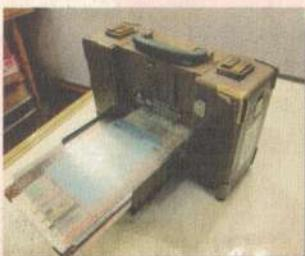
Электрическая машинка для тиснения по бумаге (эмбоссирования)
